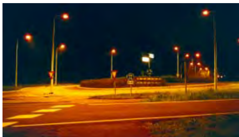
Hoge druk Natrium. Goed te richten, weinig vervuilende componenten.
