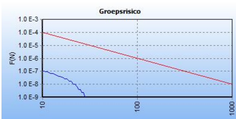
Figuur 6: FN curve voor leiding-W-570-23-deel-1 van N.V. Nederlandse Gasunie voor de kilometer tussen stationing 2950.00 en stationing 3950.00 ( toekomstige situatie ). Blauwe lijn is berekende groepsrisico, rode lijn is oriëntatiewaarde.
